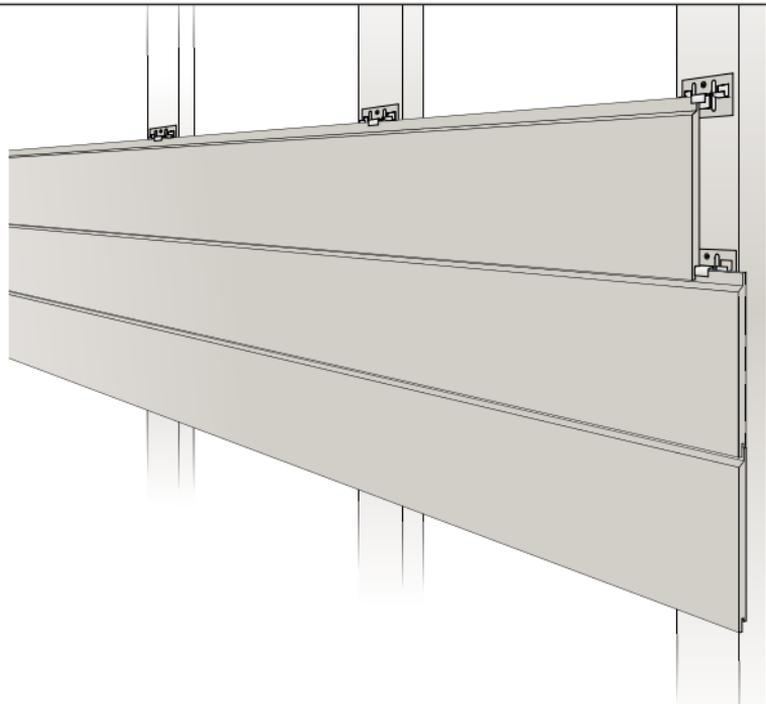
Нижний край первой доски устанавливается в стартовый профиль и проверяется строительным уровнем, если первая доска установлена в уровне - верхний край прижимается к подсистеме кляймером. Далее монтаж осуществляется при помощи кляймеров.
