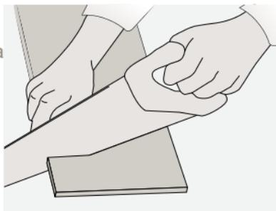
**Внимание!** Резка и сверление материала должны осуществляться в сухом, хорошо проветриваемом помещении. Обязательно удалите пыль после резки с лицевой стороны доски с помощью мягкой тряпки из микрофибры.
